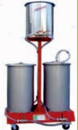
Separación de aceite de forma natural y en frío a través del agua. Los sedimentos y restos se depositan en el fondo a la vez que el aceite puro es evacuado por la parte superior.
