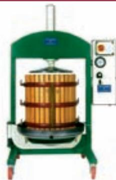
**Prensa de vino hidráulica motor**
