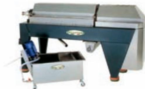
**Almazara automática línea de producción de aceite en continuo 250 kg/hora. Potencia: 16 kw 380V**
